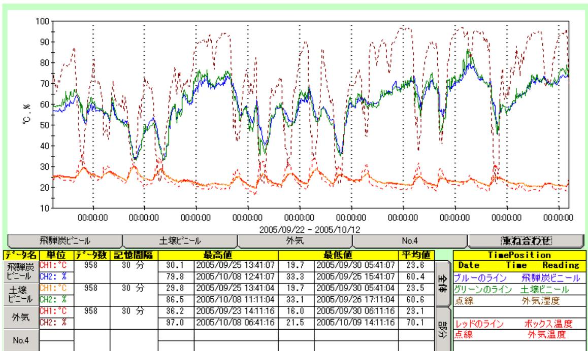
飛驒炭マットビニールと土壌ビニールの調湿比較を行った。外気湿度で90%以上の時は雨が降っている時である。雨が降っている時は飛驒炭マットの方が湿度を抑えていることが分かる。また温度が上がり湿度の低い時には、飛驒炭マットが湿度を放湿するため若干湿度が高めになる
