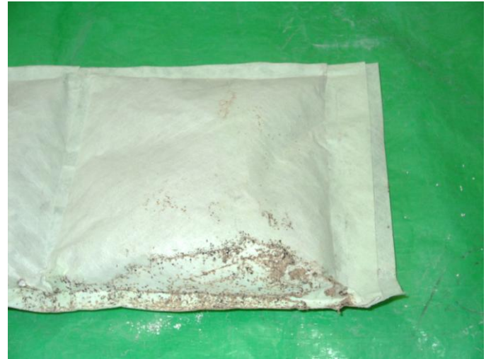
マットに小さな穴を開けたが進入は無かった
