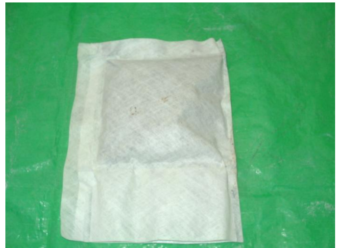
シロアリはマットに穴も開けず食害もありませんでした。
